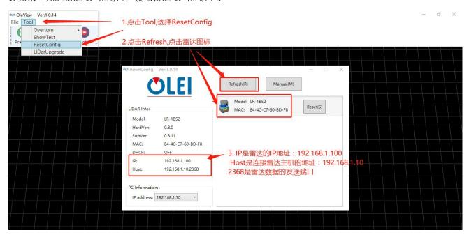
2. 选择雷达型号,填写雷达 IP 和端口号
