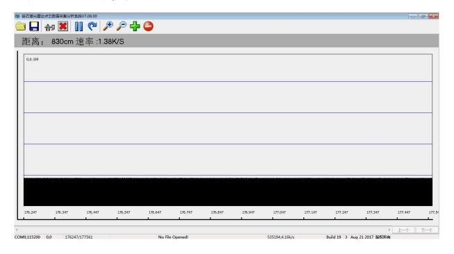
串口连接成功后,菜单栏下面会显示测试距离及速率。可通过按钮进行文件保存,时间轴和高度 轴的缩放,也可同时查看两路输出波形等。菜单栏的每个按钮,将鼠标移上时都有具体功能说明。
